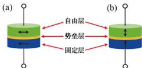
图1 MTJ结构图 (a) IMTJ (b) PMTJ
