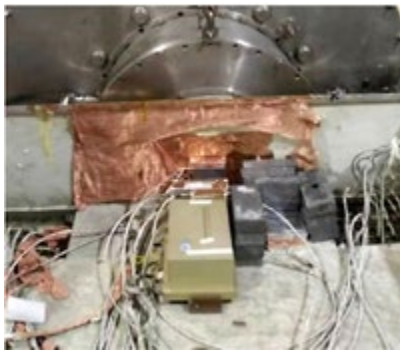
图6 瞬时剂量率试验现场装置
